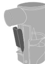
**Наденьте крышку распылителя на емкость для лекарств:** совместите крышку распылителя с емкостью для лекарств таким образом, чтобы выступы на крышке вошли в углубления на камере, потом поверните крышку по часовой стрелке.
